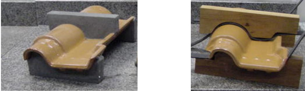
Figura 01 – Amostra A, confecção dos apoios e cutelo em argamassa (esquerda) e Amostra B, confecção dos apoios e cutelo em madeira dura (direita).
