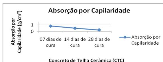
Figura 09 – Absorção por Capilaridade do Concreto de Telha Cerâmica Vermelha (CTC). Dados em g/cm<sup>2</sup>.
