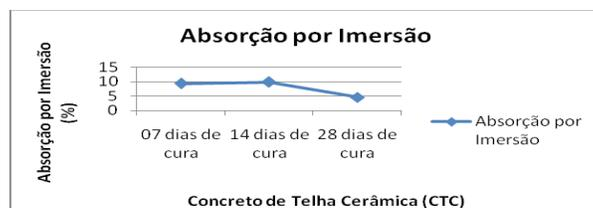
Figura 8 – Absorção por Imersão do Concreto de Telha Cerâmica Vermelha (CTC). Dados em %.
