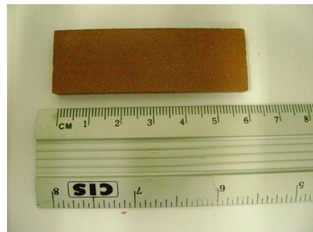
**Figura 3** - Corpo de prova compactado.
