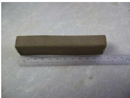
**Figura 2** – Corpo de prova extrudado.
