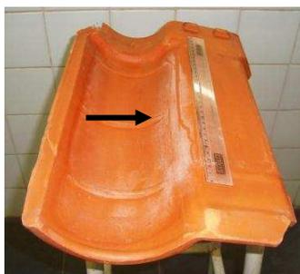
Figura 4 – Telha com eflorescência, Piauí
