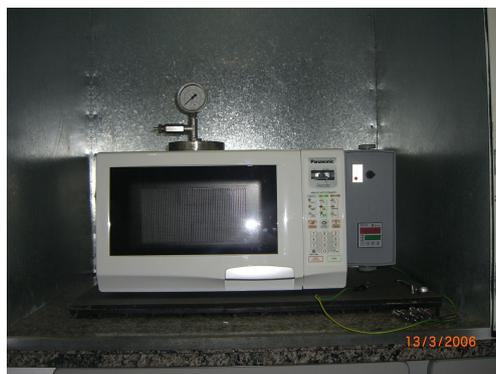
**Figura 1:** Microondas doméstico adaptado
