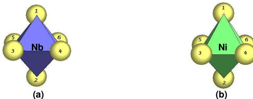
**Figura 3:** Representação esquemática de um sítio octaédrico. (a) Sítio octaédrico de  $\text{NbO}_6$  e (b) Sítio octaédrico de  $\text{NiO}_6$ .
