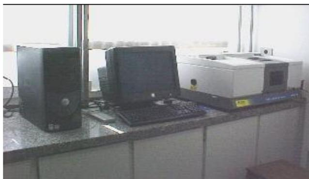
**Figura 2.** Fotografia do espectrofotômetro de absorção na região do infravermelho DIGILAB modelo Excalibur com transformada de Fourier, utilizado para a caracterização das fases cerâmicas.
