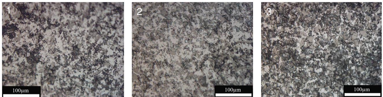
Figura 5. Micrografias dos corpos de prova: composição 1; composição 2 e composição 3, para tempo de sinterização de 4 horas.
