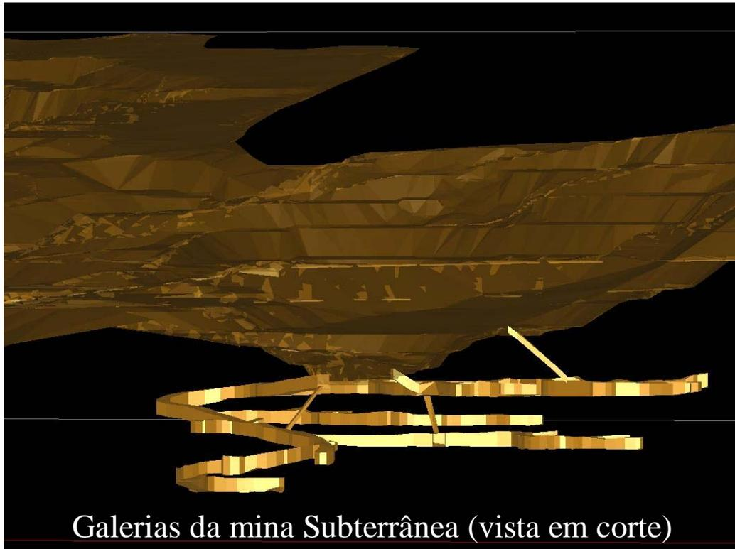
Figura 4. Vista em corte das galerias da mina subterrânea.
