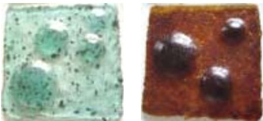
Fig. 4 - Peças em vidro automotivo (esq.) e de garrafa (dir.) queimadas à 850°C. (Arquivo pessoal, 2006)
