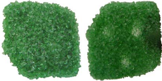
Fig. 3 Resultados do ensaio de queima à 800° C. (Arquivo pessoal, 2006)
