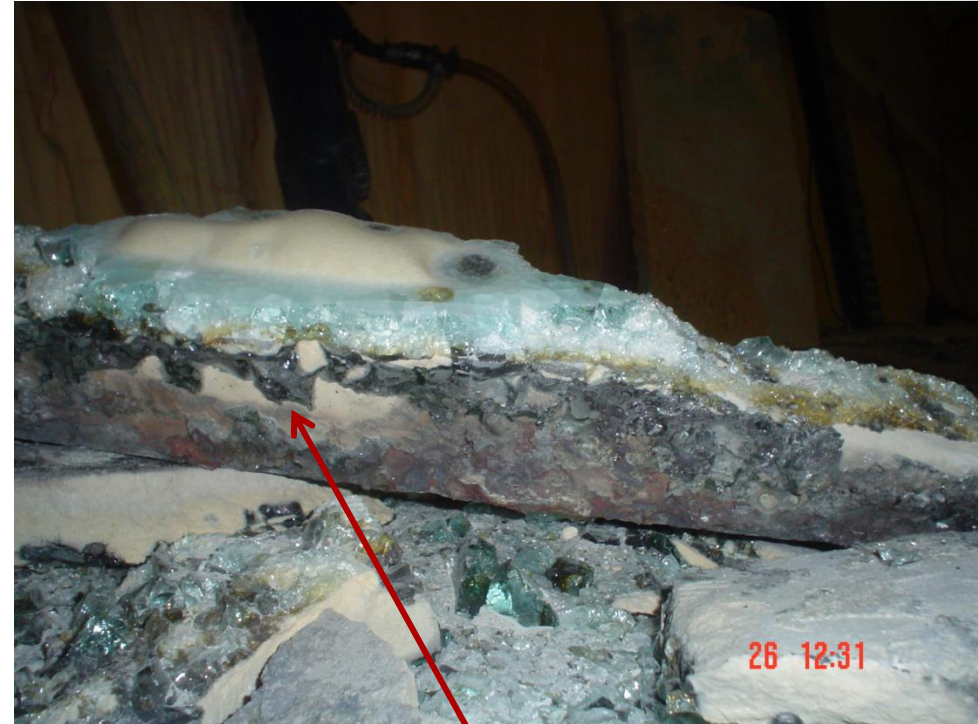
Ataque de refratário por Metal na soleira do forno
